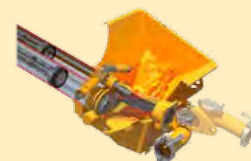
Поршневой насос с S-образным трубчатым шибром продольно расположенный
