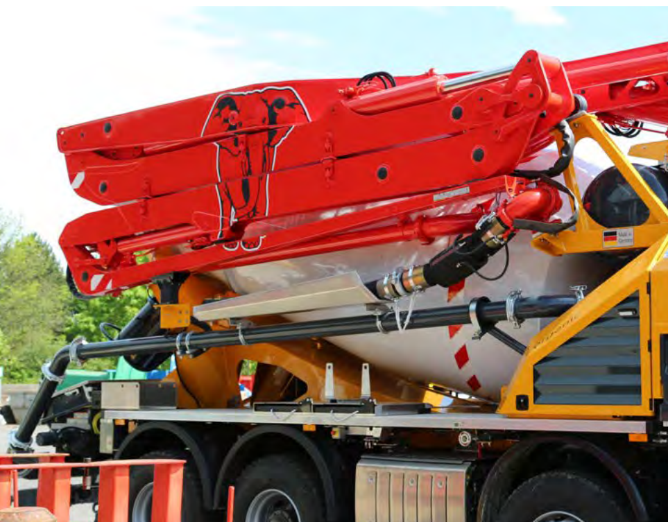
4-секционная распределительная стрела имеет наилучшие характеристики раскладывания и максимальную дальность подачи
